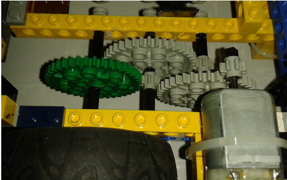
Abbildung 1: Motor mit 1:125 Getriebeuntersetzung
